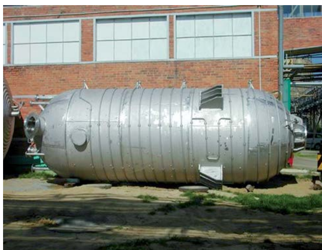
Reaktor; \varnothing 2,6 \text{ m} ; L = 8 \text{ m}
