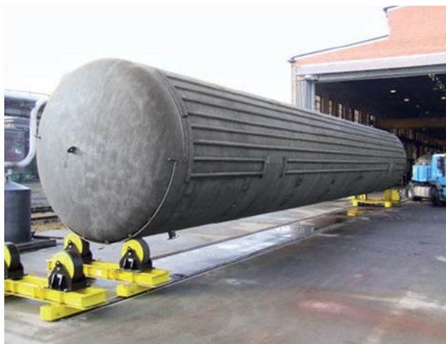
Zbiornik magazynowy; V = 200 \text{ m}^3 ; \varnothing 3,4 \text{ m} L = 23 \text{ m} ; Masa \approx 43 \text{ t}
