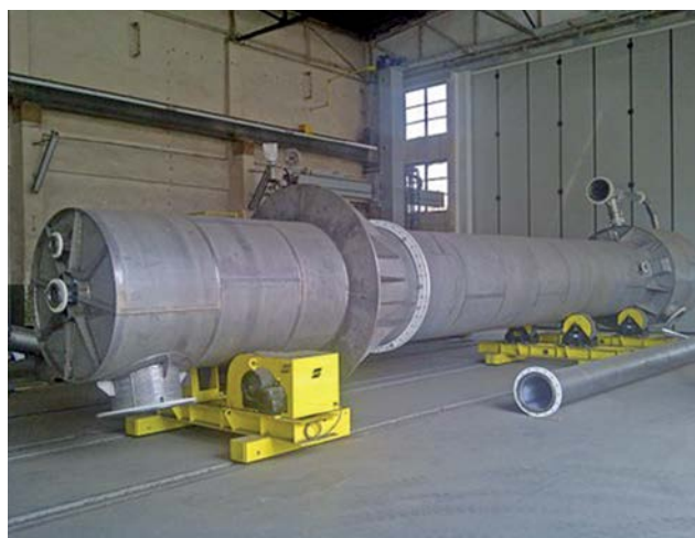
Reaktor; \varnothing 1,5 \text{ m} ; H = 20 \text{ m} ; Masa \approx 7 \text{ t} Tytan grade 2 i grade 7
